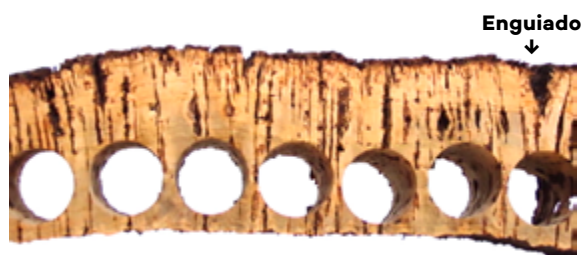
Figura 25 – Rabanada de calibre Grossa onde o enguiado não prejudica a brocagem de rolhas naturais
