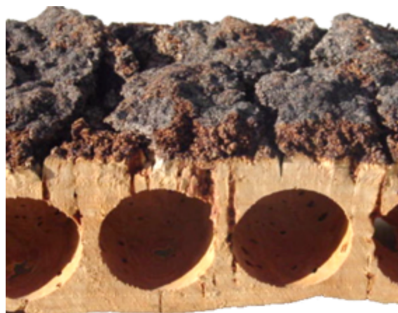
Figura 27 – Rachado profundo sem influência na qualidade das rolhas
