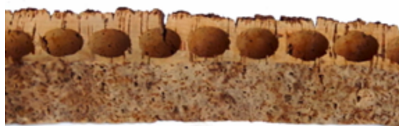
Figura 26 – Rabanada de Marca onde é possível brocar rolhas naturais com qualidade apesar da barriga irregular e preguenta
